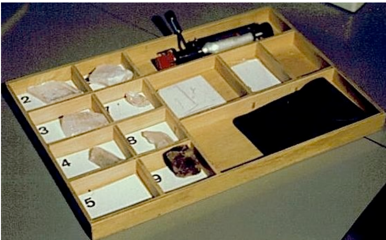
Boîte pour les tests de dureté, de fusibilité et de mesure du trait.
