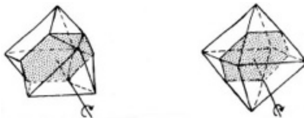
Loi de macle du spinelle. On distingue le plan de macle et l'axe de macle
